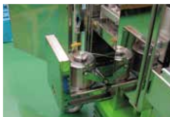
放射性藥品原液置於防護鎢罐
